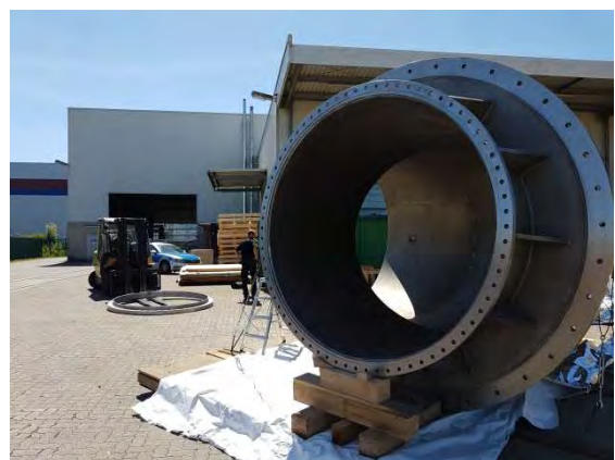
Krümmer, wo der Druckflansch verschraubt war
