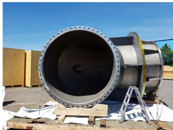
Krümmer, wo der Druckflansch verschraubt war
