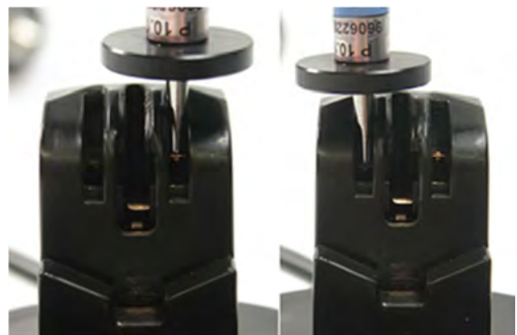
Kontakte in Abstellvorrichtung mit Prüffinger 13 berührbar
