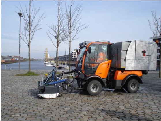
Heißwasserverfahren, hier „Wave“ in der Überseestadt
