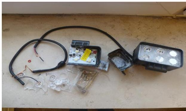
Abb. 14: LED Modul vor und nach der Prüfung
