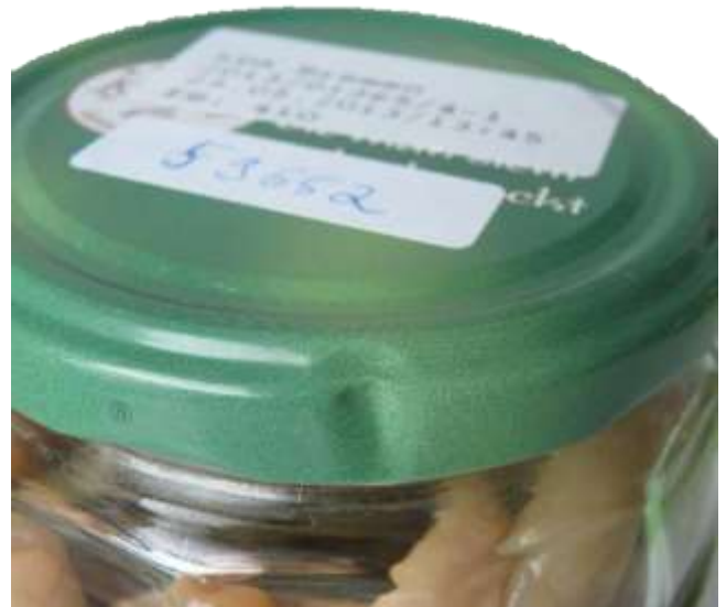
Deckelrand mit Beschädigung
