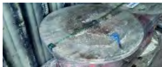
Kabeltrommeln mit stark verschimmeltem Holz
