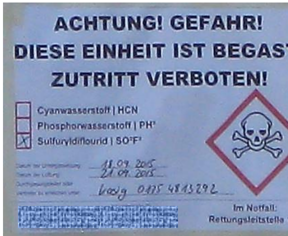
Abb. 4: Zugangskennzeichnung gemäß TRGS 512
