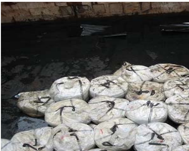
Abb. 25: Big Bags mit beschädigtem Feststoff durch falsche Beladung und Verpackung
