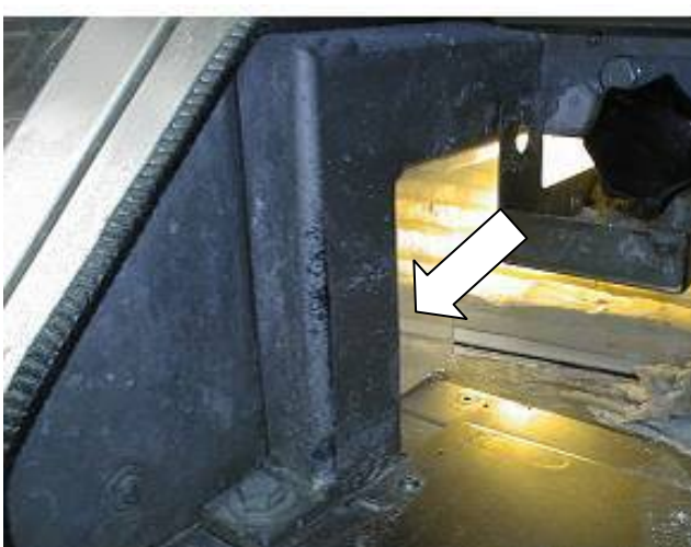
Abb. 21: Teigteilmaschine mit montierter Schutzscheibe
