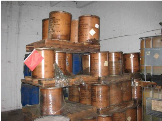
Abb. 44: Unsichere Lagerung der Gebinde
