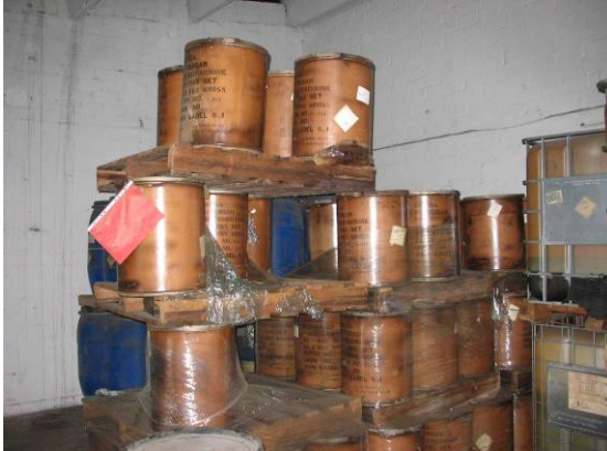
Abb. 44: Unsichere Lagerung der Gebinde
