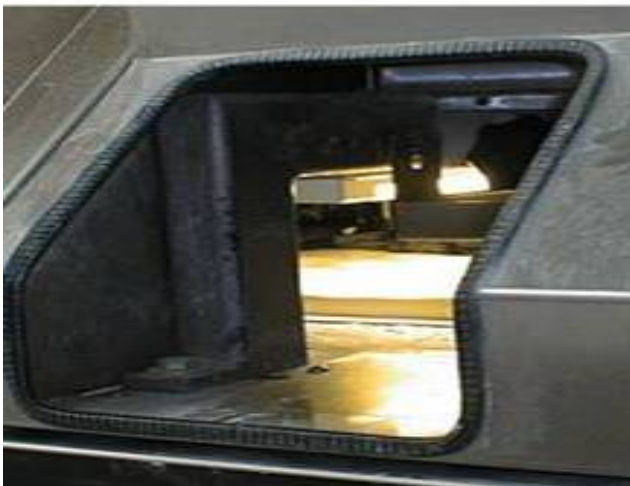
Abb. 20: Teigteilmaschine mit fehlender Schutzscheibe
