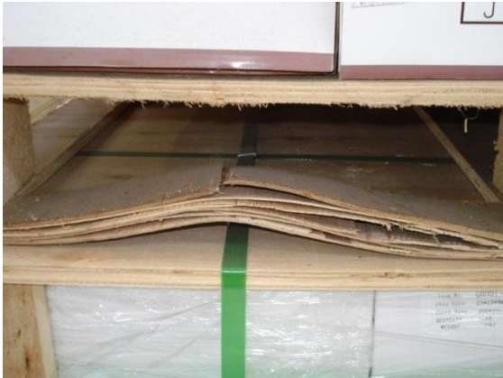
Bild: Aufgeweichte Paletten aus Pressholz
