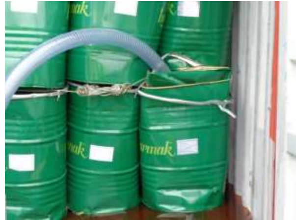
zerdrückte Honigfässer mit Kontamination des Containerbodens
