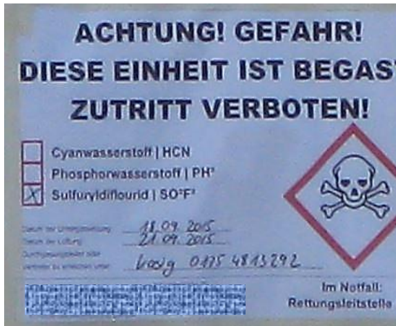
Abb. 4: Zugangskennzeichnung gemäß TRGS 512
