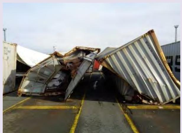
Havarierte Container der MSC ZOE im Containerdorf auf dem Eurogate-Terminal Bremerhaven
