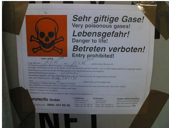
Abb. 7: Kennzeichnung eines Containers während einer Begasung mit Brommethan
