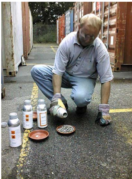
Abb.: 1 Containerbegasung mit Phosphorwasserstoff. Der Wirkstoff wird aus Aluminiumphosphid-Tabletten freigesetzt.
