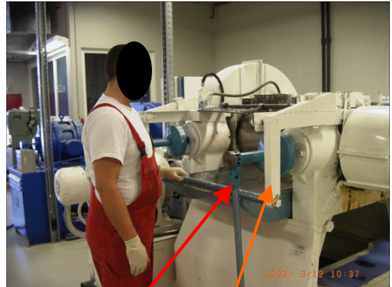
Sicherheitsbrücke mit Not-Aus-Funktion
