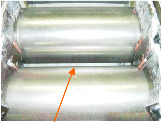
Üblicher Walzenabstand 5 bis 7 mm
