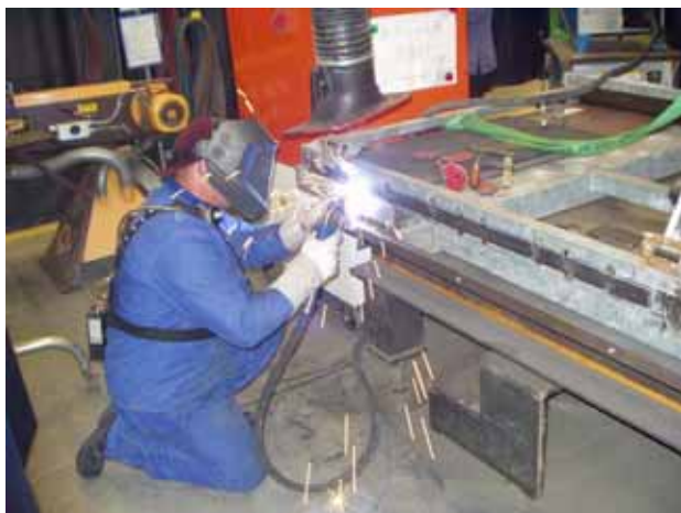
Abb. 42: Schweißen verzinkter Oberflächen
