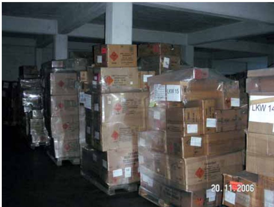
Abb. 46: Unzulässig gelagerte Paletten mit Silvesterfeuerwerk
