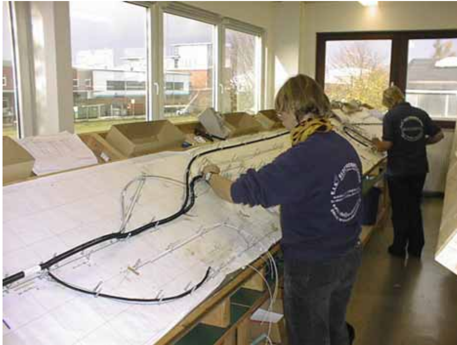
Abb. 21: Ergonomischer Montageplatz für die Kabelkonfektion
