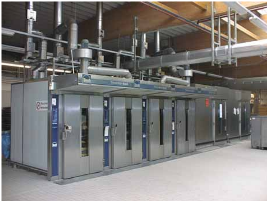
Abb. 19: Stikkenöfen einer modernen Großbäckerei
