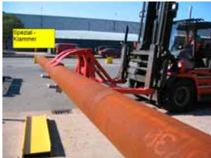
Abb. 29: Rohrtransport mit Spezialklammer
