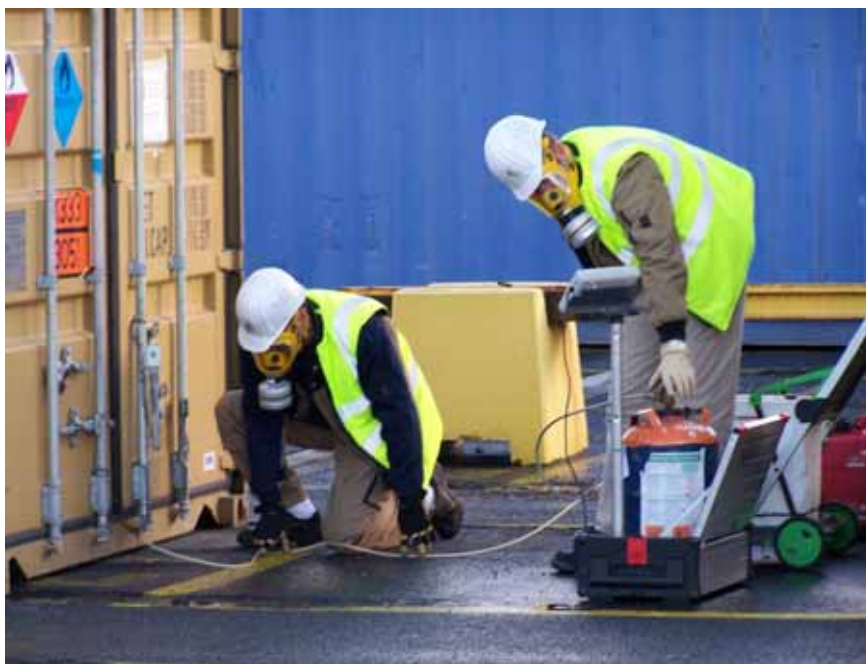
Abb. 38: Begasung von Verpackungsholz im Container mit Brommethan
