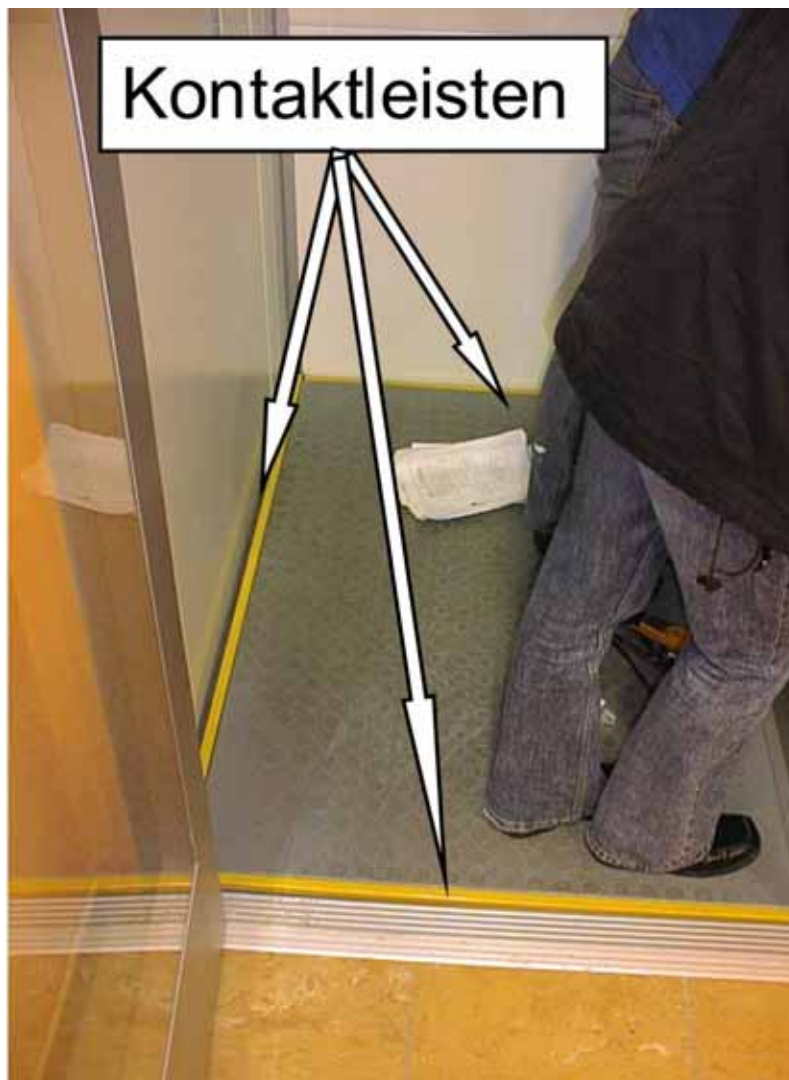
Abb. 36: Förderplattform der Maschine zum Heben von Personen
