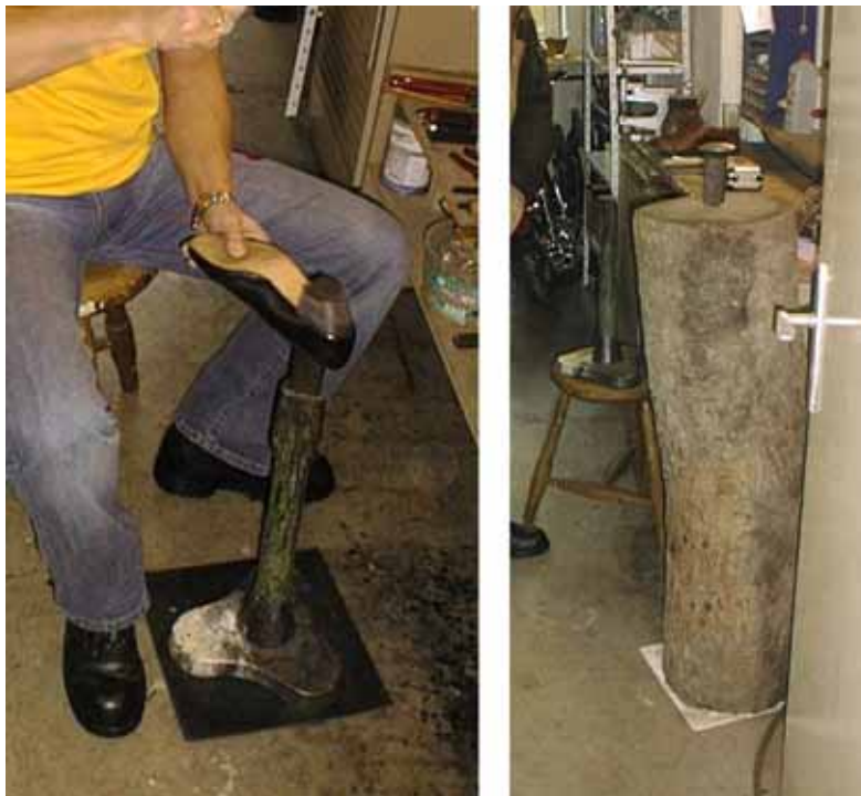
Abb. 60 Anklopfen von Klebeverbindungen vorher/nachher
