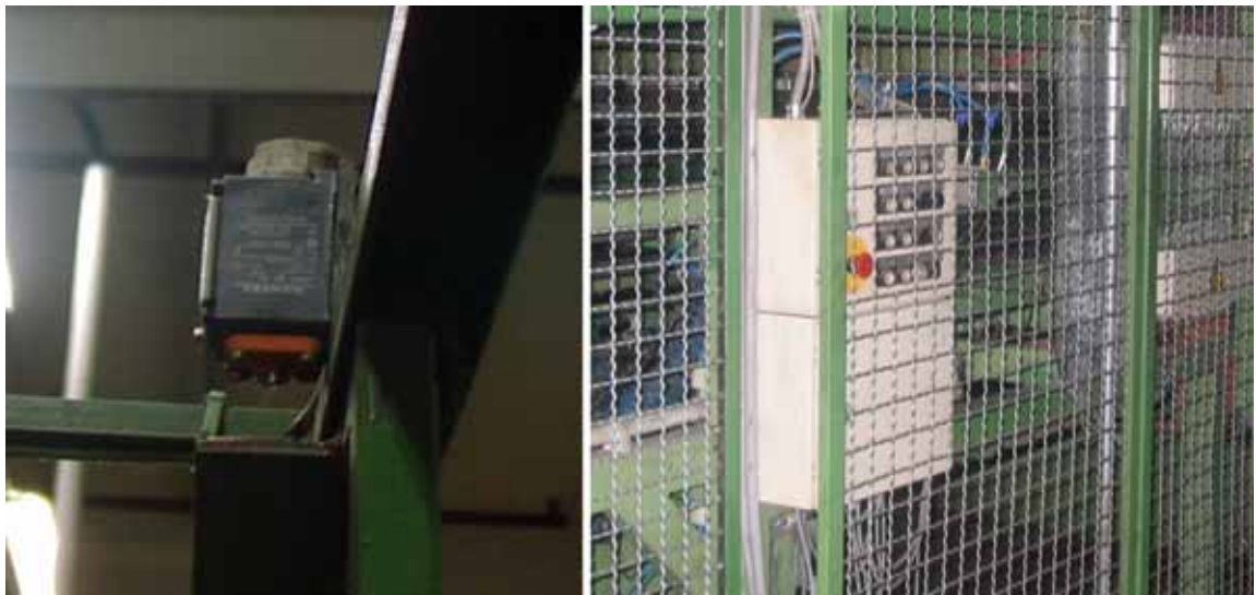
Abb. 11: Mangelhafte Endschalter (links); Nicht erreichbarer Not-Aus-Taster (rechts)
