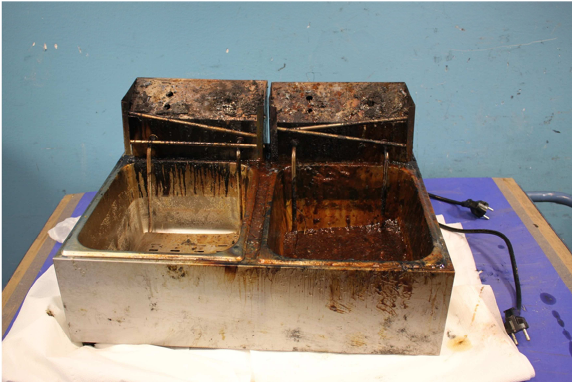
Foto der abgebrannten Fritteuse
