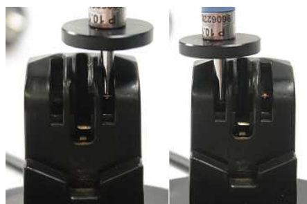
Bild 2: Kontakte in Abstellvorrichtung mit Prüffinger 13 berührbar
