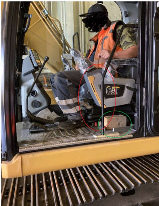
Nachgestelltes Foto der Fahrsituation mit dem Unterlegholz in der Fahrerkabine (grüner Kreis), im roten Kreis ist der Sicherungsbügel zu sehen. Bei dieser Stellung des Sicherungsbügels sind keine Steuerbefehle möglich. Darüber befindet sich der Hebel für die Drehbewegungen des Oberwagens.
