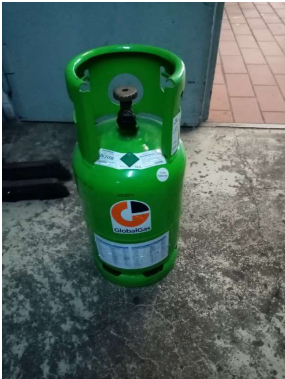
Pfandflasche für R134a: Dieses Kältemittel wird z. B. in älteren Kfz-Klimaanlagen verwendet
